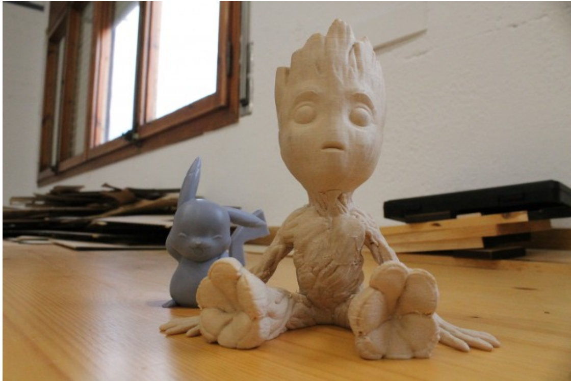
Dues figures creades amb impressores 3D, la de l'esquerra feta amb filament i la de la dreta amb resina Foto: Anna Pujol Navarro
